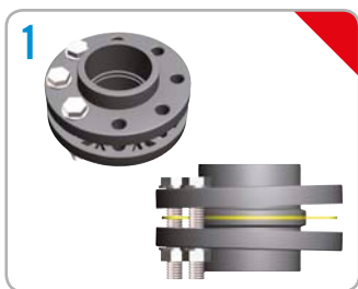
1. Modo incorrecto de apriete.
